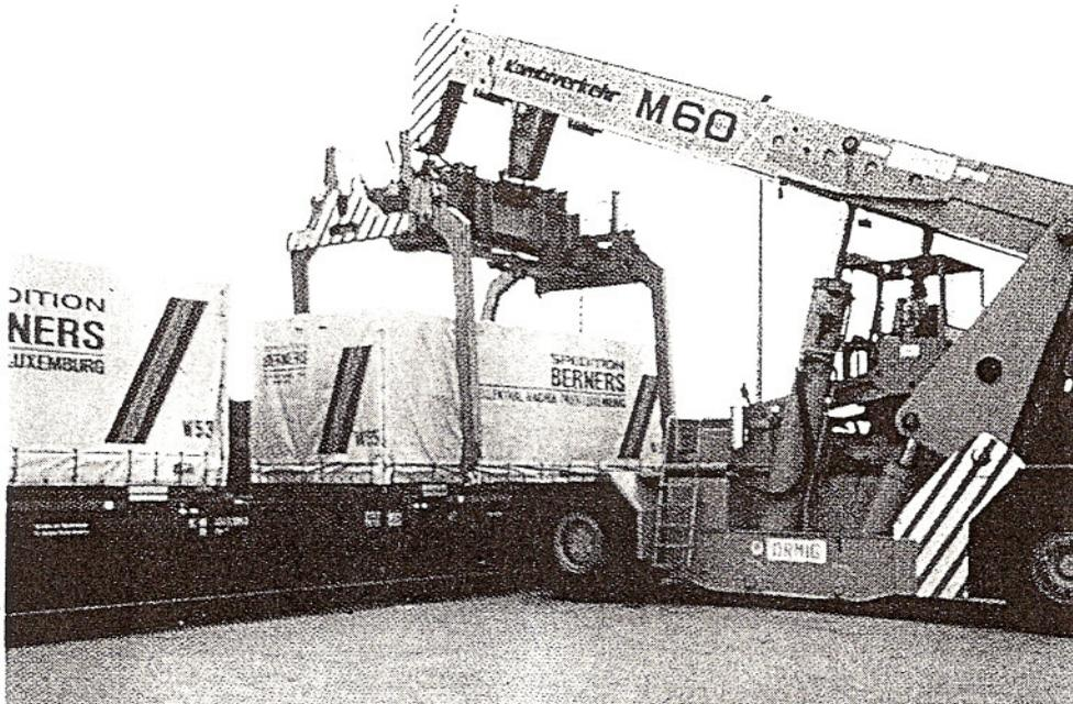
Abb. 4: Umschlag eines Wechselbehälters mit mobilem Containerlader (Quelle: DB)
